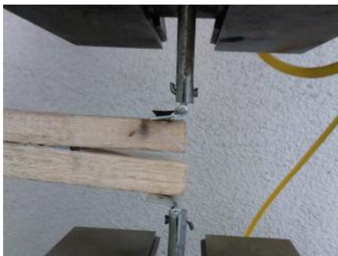
شکل 2: تست مود اول شکست
