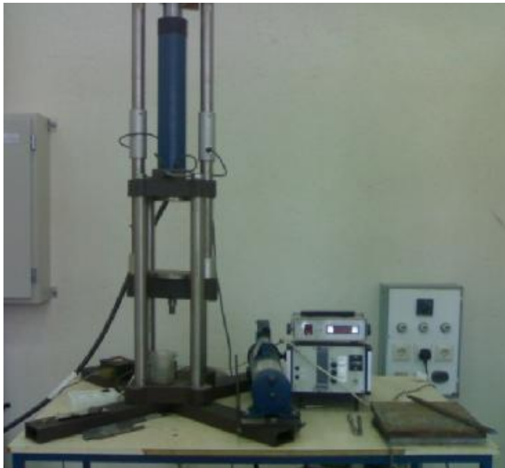
شکل 4: دستگاه تست خستگی هیدرولیک
